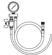
Manómetro para medir presión de bomba de gasolina con válvula de descarga. Las principales causas de una baja de presión pueden ser: fatiga de la bomba, filtro primario tapado que se encuentra dentro del tanque de gasolina, filtro de gasolina tapado o falta del regulador de presión.
