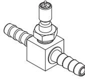
Adaptador "T" para medir la presión de la bomba de gasolina en autos Nissan y VW. Si se ahorca uno de los extremos, funcionara también como adaptador lavador de inyectores.
