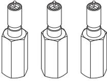
Los adaptadores rectos conectan el equipo al riel de gasolina de los inyectores. Si el vehículo cuenta con líneas de entrada y retorno estas deben bloqueadas para el uso de los adaptadores. Estos adaptadores funcionan para autos de las marcas Ford; VW y Nissan; GM y Chrysler.
