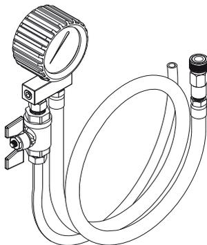
El manómetro de gasolina se usa para verificar el correcto funcionamiento de la bomba de combustible.
