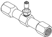
"T" para medir presión de bomba de gasolina lado filtro de gasolina en sistemas de inyección TBI GM.
